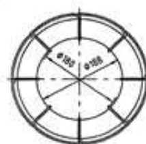
Στροφέας 75 Συρμάτινος στροφέας με πλαστική επικάλυψη Διάμετρος οπή 180 mm Περιέλιξη σε στρώσεις EN 759: K300
